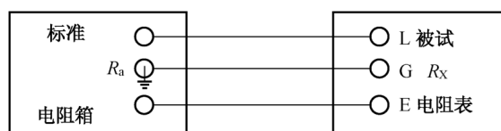
图 1 绝缘电阻表误差试验接线图
